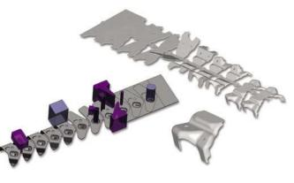
Mit den Tools benötigt Marc Löhmann auch bei komplexeren Teilen nur rund eine halbe Stunde für ein Streifenlayout, das bereits für die Angebotserstellung ausreicht.
