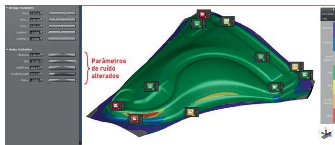
Figura 4b: Simulação representando uma combinação de valores dos parâmetros de ruído que levou ao aparecimento de defeitos na peça.
