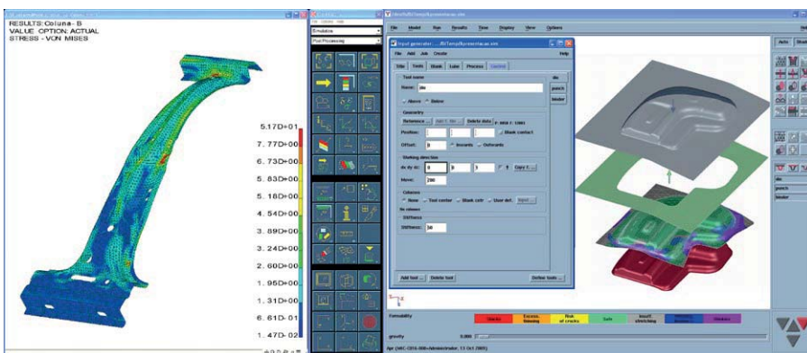
Figura 1: Exemplos simulações pelo Método dos Elementos Finitos para simulação estrutural, do processo de forjamento e do processo de estampagem de chapas.
